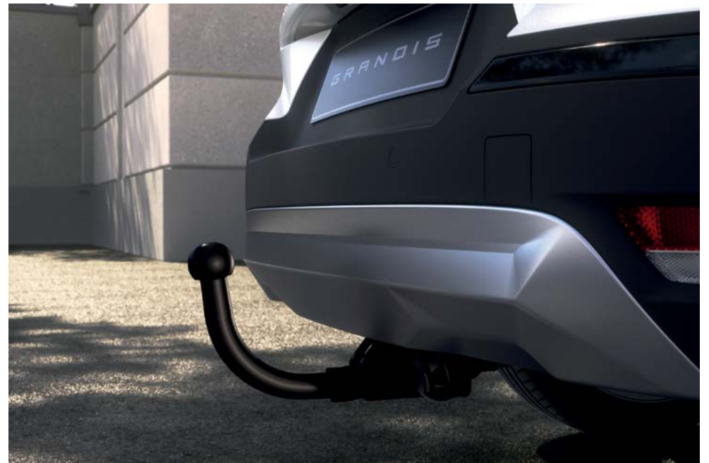
▲ Pevné tažné zařízení Včetně 13pólové elektroinstalace MZ315549K1
